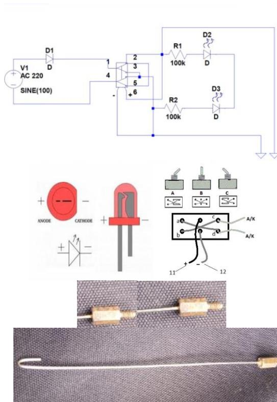
Gambar 4. Cara penyambungan tegangan satu fasa, saklar, LED serta electrode pada water ionizer
