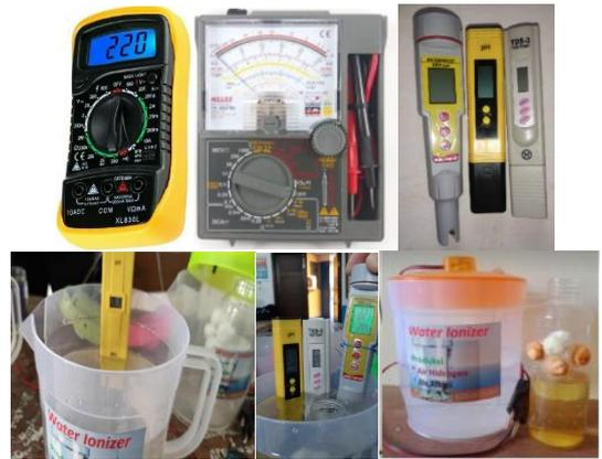
Gambar 5. Alat ukur Pengujian water ionizer dan hasilnya air alkali dalam teko dan air asam dalam botol
