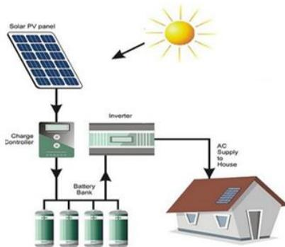
Gambar 2.1 Instalasi Pembangkit Listrik Tenaga Surya off grid.
