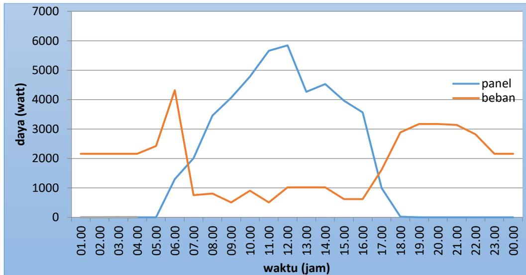
Untuk menghitung kapasitas baterai yang digunakan, analisis ini menggunakan sistem dimana beban yang digunakan saat masa pengisian panel langsung terhubung dari sistem panel tanpa baterai sedangkan sisa pengisian nya dihubungkan kedalam baterai
