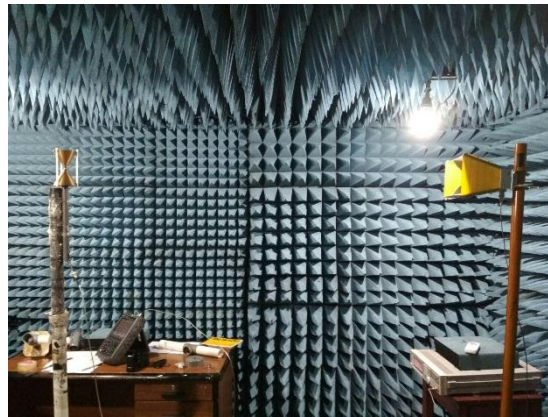
Gambar 7. Skema Pengukuran Gain dan Pola Radiasi.
