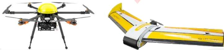
**Gambar 2.1** Klasifikasi *drone* berdasarkan bentuk sayap
