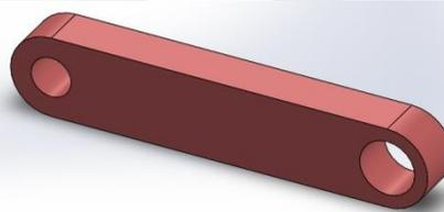
Gambar 6 Alat bantu pengecekan pein pelurus model
