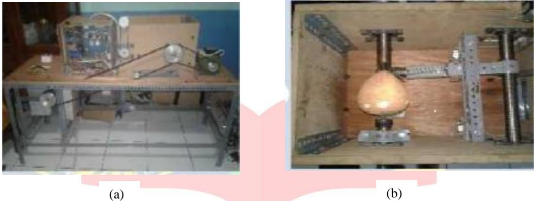
Gambar 1.1 Mesin Pengupas Kulit Ari Kelapa (a) Gambar mesin keseluruhan (b) Gambar bagian dalam mesin
