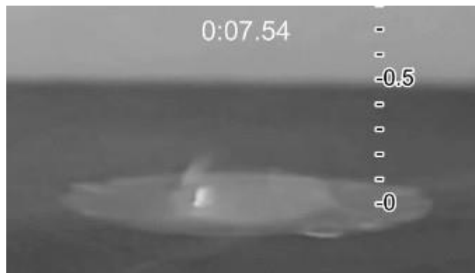
Gambar 13. Merupakan hasil dari pipet 0.5cm dengan jarak 10cm dapat menghasilkan waktu 07.54 detik, dan mendapatkan jarak pantul droplet 0.5cm
