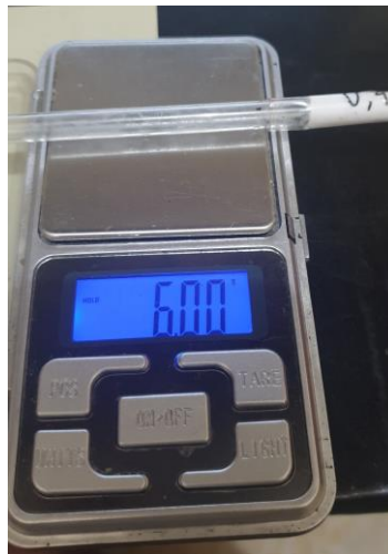
Gambar 19. timbangan massa pipet diameter 0.4cm yang sudah terisi air
