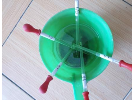
Gambar 4. Media sudah terisi kedalam pipet dengan pengisian setiap pipet minimal 5cm.
