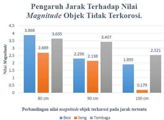
**Gambar 9** Pengaruh jarak terhadap nilai *magnitude* pada objek yang tidak korosi.
