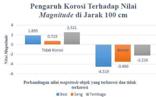
**Gambar 8** Grafik pengaruh korosi terhadap nilai *magnitude* di jarak 100 cm. Gambar 8 menunjukkan pada jarak 1 meter, perbedaan tingkat korosi sangat terlihat dibandingkan dengan jarak 80 cm dan 90 cm. Dengan penurunan nilai *magnitude* masing-masing objek mencapai 3 dBm.
