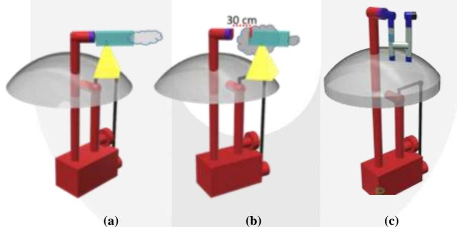
**Gambar 2.** Teknik pengukuran ketika alat ukur dipasang pada (a) posisi tanpa jarak dan (b) dengan jarak 30 cm dari cerobong, serta (c) penempatan alat kondensator untuk mengambil cairan dari asap hasil pembakaran.
