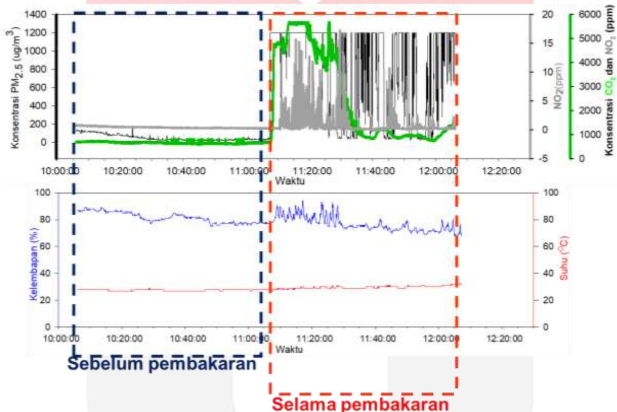
**Gambar 4.** Pengukuran konsentrasi CO<sub>2</sub>, NO<sub>2</sub>, dan PM<sub>2.5</sub> serta temperatur (T) dan kelembapan relatif (RH) sebelum dan selama proses pembakaran.
