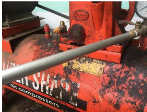
Gambar 3.5 Pemasangan Silinder Berdiameter 1 cm
