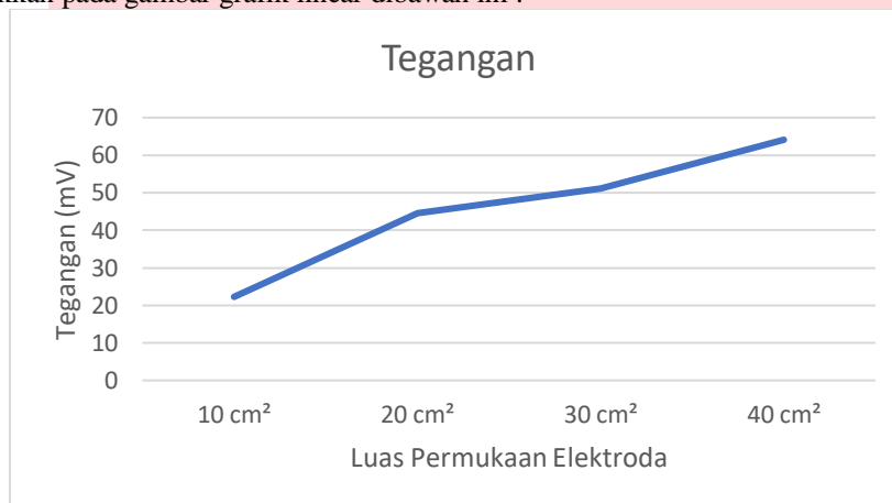
Gambar 4.9 Hasil pengukuran tegangan terhadap luas permukaan elektroda terdistribusi
