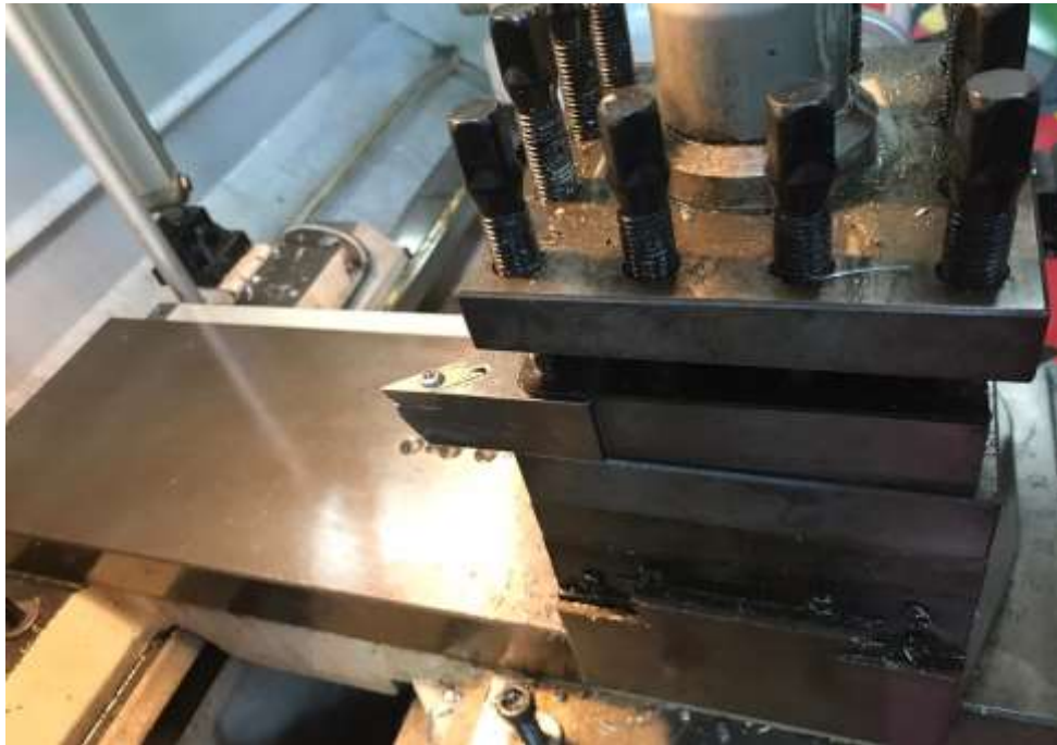
Gambar 4 pemasangan holder konvensional pada toolpost
