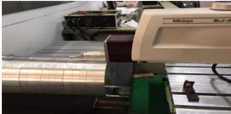
Gambar 9 Pengukuran kekasaran permukaan
