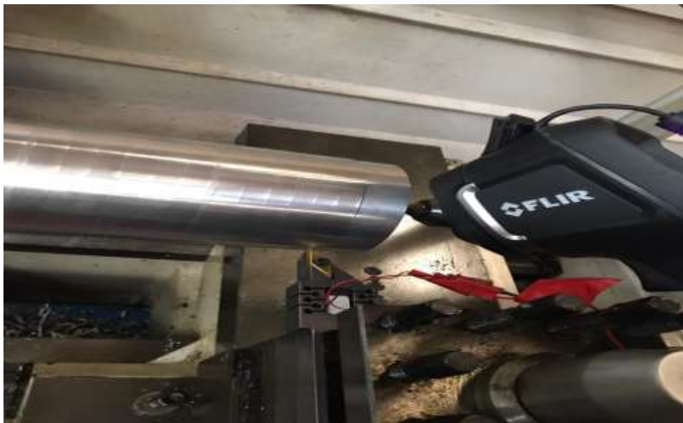
Gambar 5 Pemasangan simplified Holder pada Toolpost
