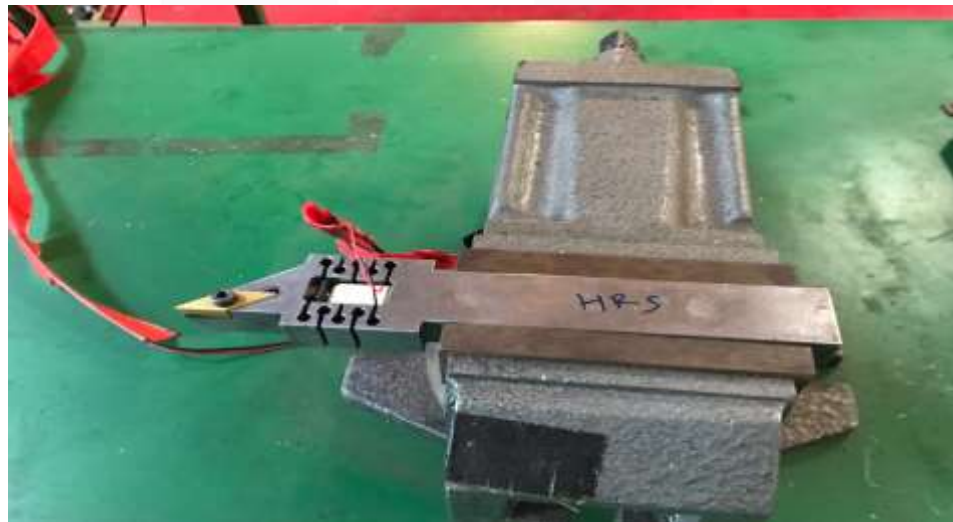
Gambar 7 Memasang piezoo pada holder
