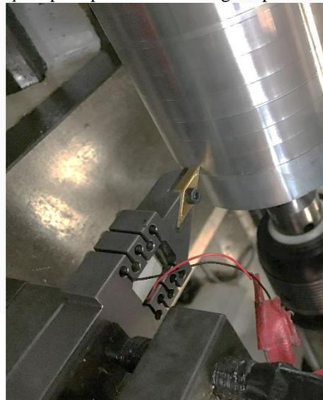
Gambar 4 Posisi Holder Pada *Toolpost*
