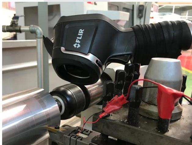
Gambar 7 Posisi Kamera Flir E6
