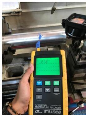
Gambar 10 Pengukuran Suhu Pada Area Pemotongan
