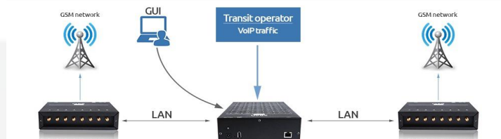
Gambar 1 Cara Kerja SIM Box [9]
