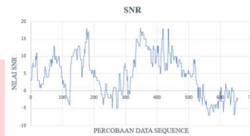
Gambar 12. Perolehan nilai SNR dari drive test dengan UAV
