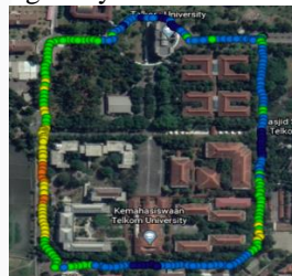
Gambar 10. Penyebaran titik sequence dalam drive test dengan UAV
