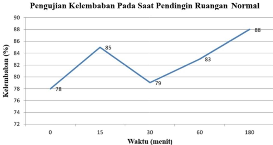
Gambar 4 Grafik Pengujian Kelembaban Pada Saat Ruangan Normal
