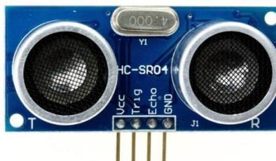
Gambar 4 Sensor Ultrasonik [8].
