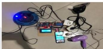
**Gambar 10.** Kondisi ketika *wireless smart energy meter* disambungkan dengan 2 perangkat(setrika dan *hairdryer*)
