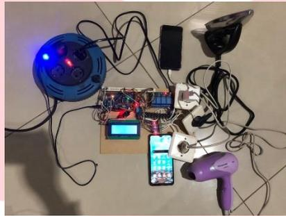
**Gambar 12.** Kondisi ketika *wireless smart energy meter* disambungkan dengan 3 perangkat (setrika, *hairdryer*, dan *charger Oppo*)
