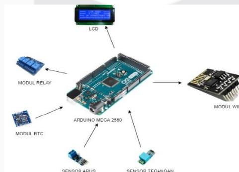
**Gambar 6** Desain Perangkat Keras pada *wireless smart energy meter*.
