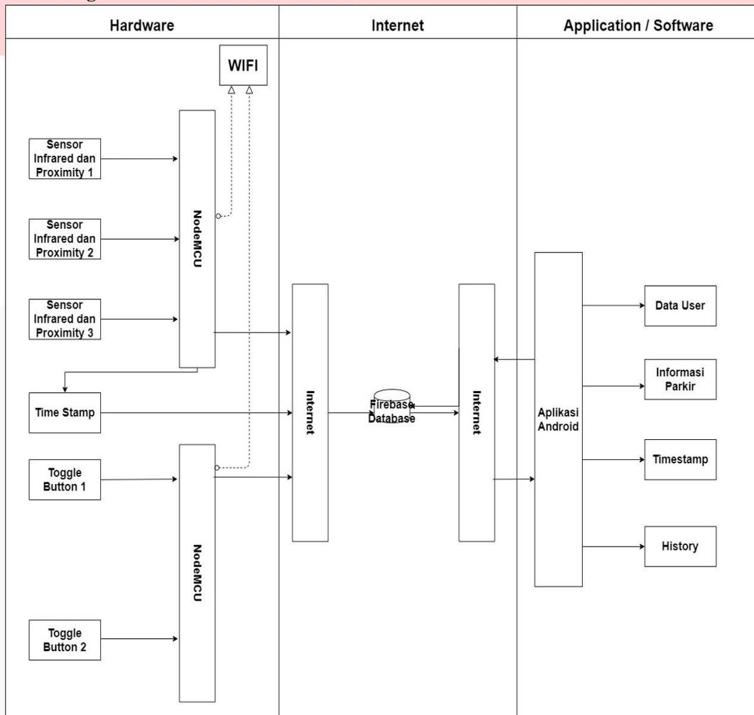
Gambar 3.2 Diagram Blok
