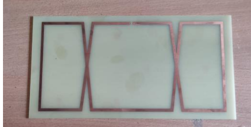
Gambar 3.3 Hasil realisasi antenna sterba curtain .
