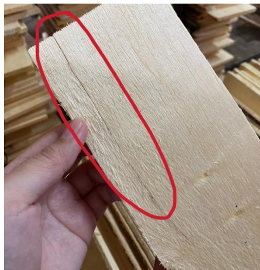
Gambar 2 Visualisasi Cacat Retak pada Slat 7A1
