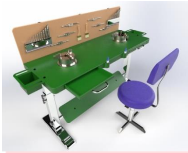
Gambar 3d. Desain Hasil Rancangan Desain meja dan kursi kerja usulan dengan telah mempertimbangkan keluhan dan kebutuhan dari pengguna. Terdapat fitur yang tidak terdapat pada desain meja dan kursi kerja sebelumnya. Penambahan fitur-fitur ditambahkan dengan mempertimbangkan postur kerja operator. Desain meja disesuaikan agar dapat digunakan dengan sikap kerja yang dinamis. Fitur-fitur tersebut memiliki kegunaan masing-masing yang akan dijabarkan pada tabel:
