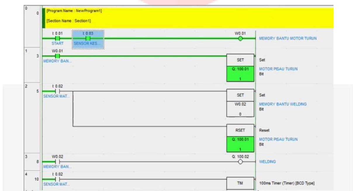
Gambar 10 Simulasi sensor mendeteksi kesesuaian raw material
