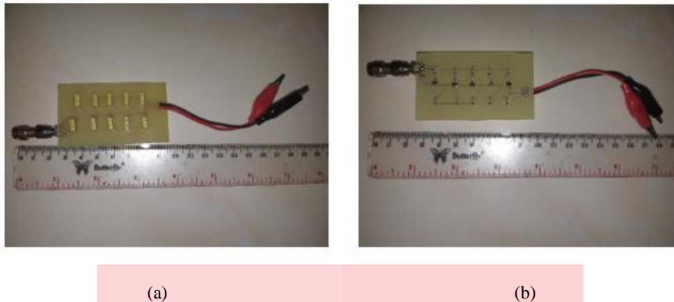
Gambar 10. Realisasi Rectifier : (a) Tampak Depan (b) Tampak Belakang
