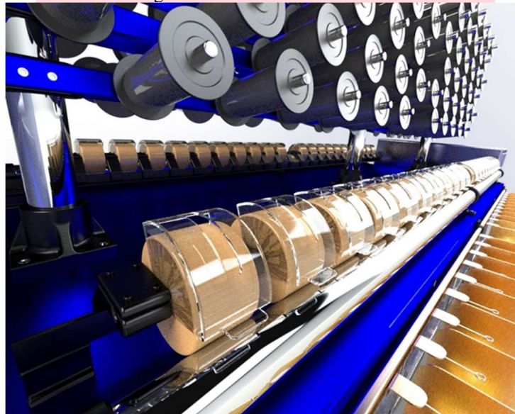
Gambar 3 Rancangan Usulan Penambahan Pembatas Antar Roda
