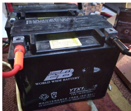
Gambar II-4. Baterai 12V, 12Ah.
