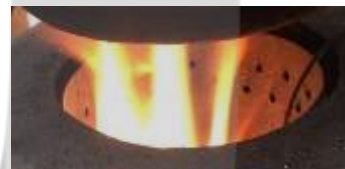
Gambar 3.14 Pola Api Pada Downdraft Direct
