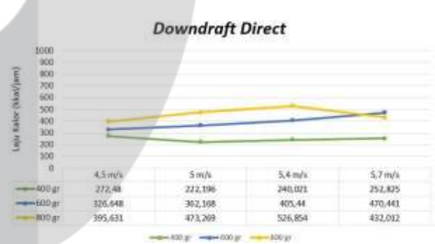
Gambar 3.26 Laju Kalor Pada Downdraft Direct
