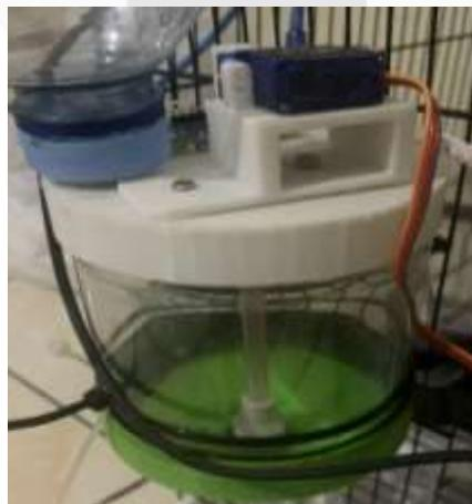
Gambar 6. Desain alat pemberi minum burung otomatis
