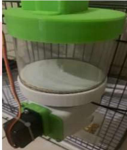
Gambar 5. Desain alat pemberi pakan burung otomatis
