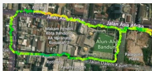
Gambar 12. Hasil drive test parameter SINR Alun-alun Bandung.
