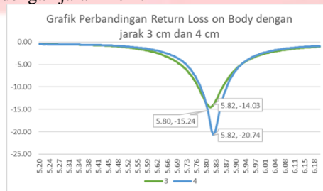
Gambar 4. 2 Grafik yang menunjukkan perbandingan return loss saat jarak antara antenna dan phantom 3 cm dan 4 cm.
