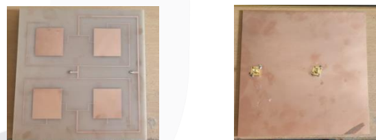
Gambar 4.1 Antena realisasi tampak depan dan belakang
