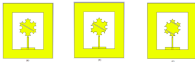
Gambar 17 (a) Single slot. (b) Modifikasi patch dan slot. (c) Modifikasi patch dan dual gap.
