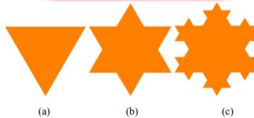
Gambar 2.2 Perulangan Fraktal Koch snowflake . (a) perulangan ke-0. (b) perulangan ke-1. (c) perulangan ke-2 [12].
