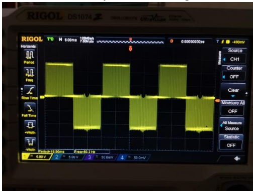
Gambar 4.2 Hasil Sinyal SPWM dengan Time/Div 5ms
