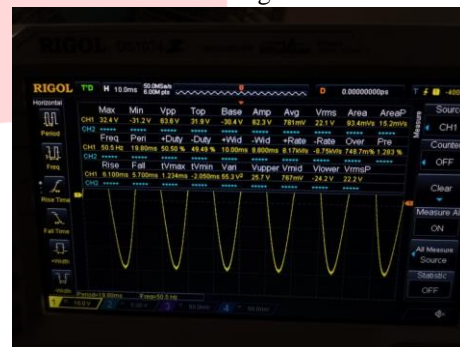
Gambar 4.4 Gelombang Keluaran Inverter
