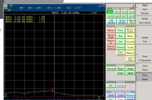
Gambar 7 (a) Grafik VSWR Pada Frekuensi ( 3.1 – 10.6) GHz, (b) VSWR Antena pada Frekuensi (3.1-10.6) GHz saat Berada Pada Phantom/Tubuh Manusia Sejauh 2 mm
