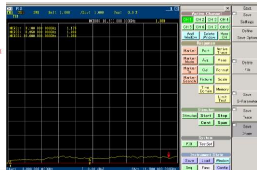
Gambar 6 (a) Grafik VSWR Pada Frekuensi ( 3.1 – 10.6) GHz di Free Space, (b) VSWR Antena pada Frekuensi (3.1-10.6) GHz saat Free Space
