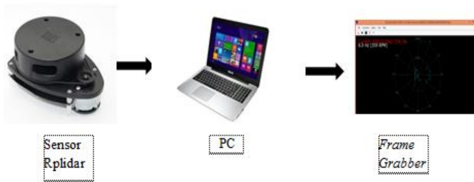
Gambar 2. Ilustrasi Sistem Monitoring Keberadaan Obstacle
