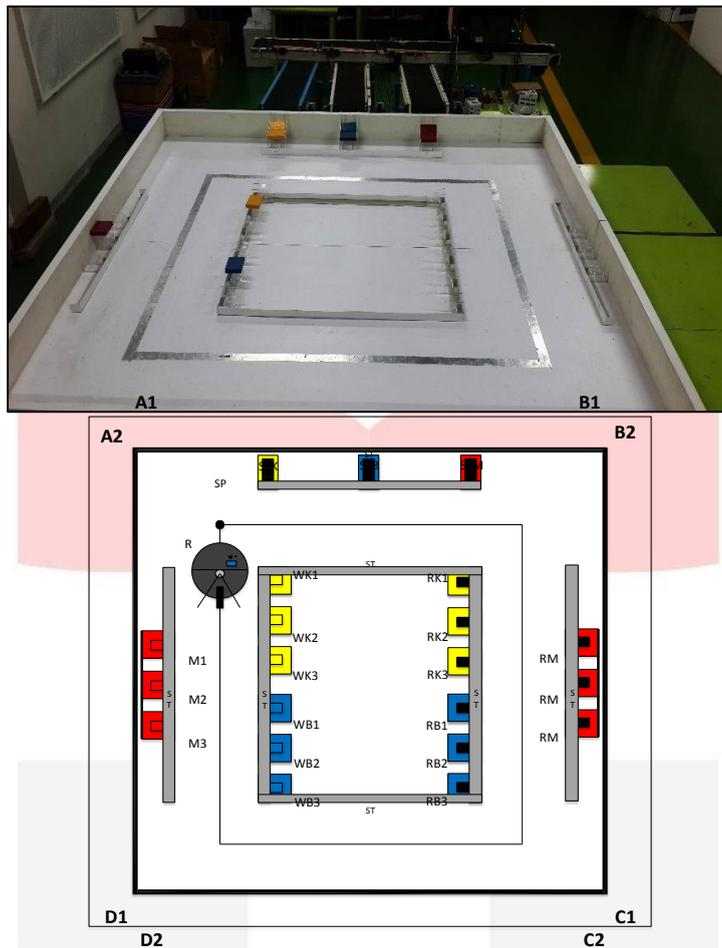
Gambar 2.1 Perancangan Arena dan Skenario Storage System
