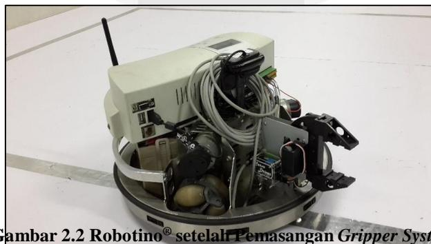
Gambar 2.2 Robotino<sup>®</sup> setelah Pemasangan Gripper System
