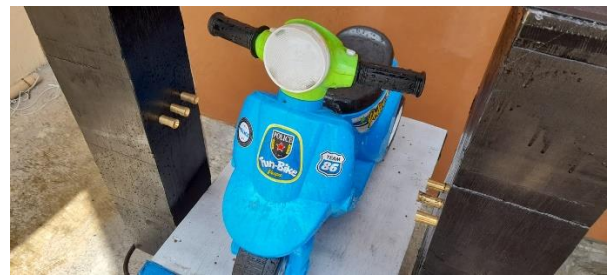
GAMBAR 4.10. Pengujian Pada Proses Pengeringan Badan Motor. Pada Tabel 14. di halaman Lampiran, didapatkan hasil perhitungan waktu pada tahapan pengeringan yang berupa penggunaan waktu yang diperlukan tiap 3 tingkatan level yang berbeda. Didapatkan rata-rata waktu yang diperlukan untuk mengeringkan kendaraan motor adalah 496 sekon atau setara dengan 8,267 menit.
