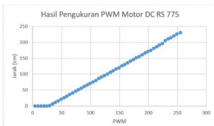
GAMBAR 4.3. Hasil Pengukuran PWM Motor DC RS 775.
