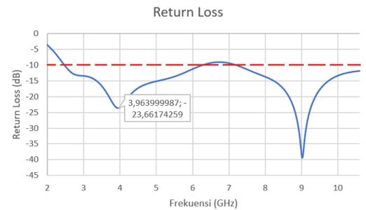
Gambar 2 Grafik Return Loss Simulasi Setelah Optimasi
