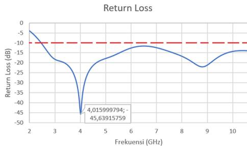
Gambar 3 Grafik Return Loss Simulasi Sebelum Optimasi
