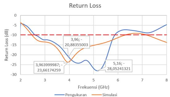
Gambar 10 Grafik Return Loss Pengukuran Tanpa Bending
