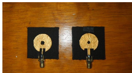
Gambar 4. 5 Tampak depan antena setelah di solder
