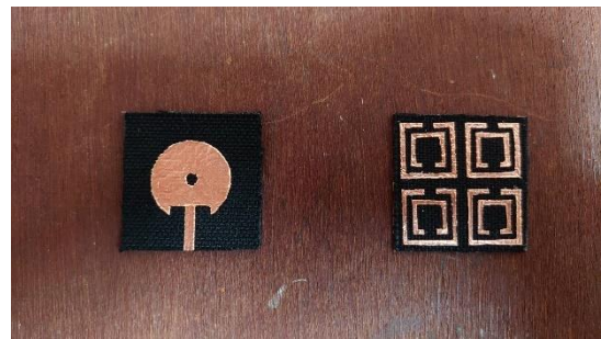
Gambar 4. 3 Tampak depan antena dengan metamaterial sebelum di satukan
