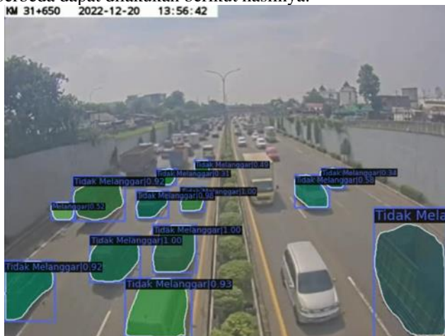
Gambar 20 Hasil deteksi video CCTV jalan tol berbeda dengan model terbaik.
