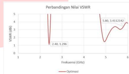
Gambar 3.9 Grafik VSWR Hasil Optimasi Substrat 4 mm
