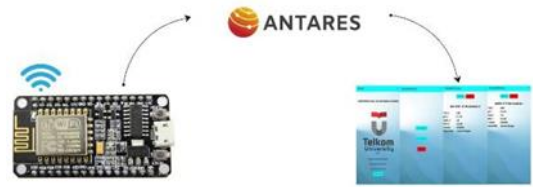
GAMBAR 3. Esp8266, Antares, dan Mobile Apps
