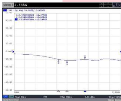
Gambar 27 Hasil Pengujian Return Loss S-Band
