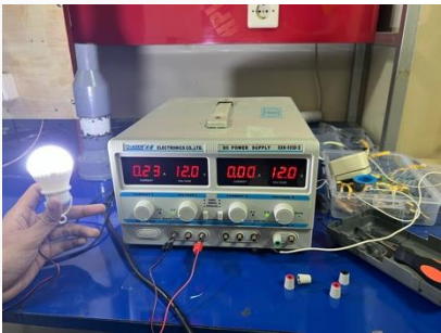
GAMBAR 2. Pengujian Beban Lampu
