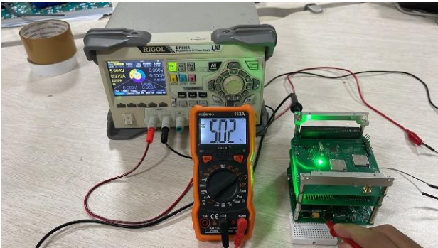
GAMBAR 3.9 Pengujian Sistem Distribusi Fix 5V & 3,3V Dengan Beban Sub-Sistem
