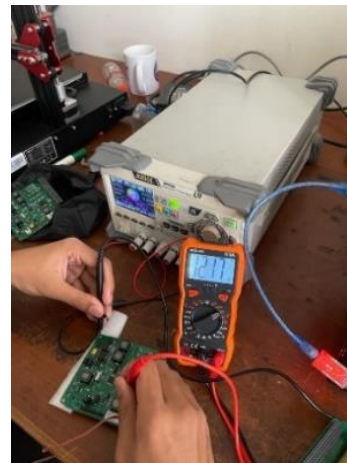
GAMBAR 3.3 Pengujian Sistem Step-Up
