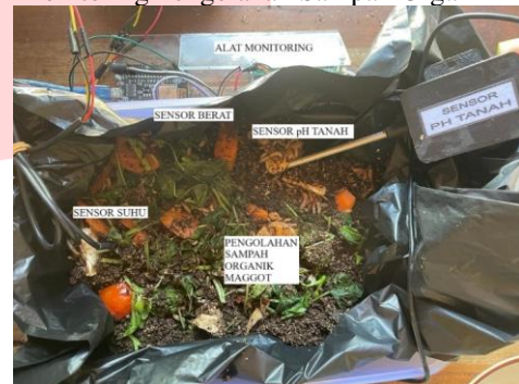
GAMBAR 9. Pemasangan Alat Monitoring
