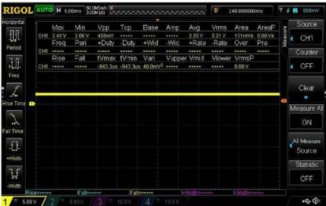
Gambar 4.2 Hasil pengujian Three Phase Rectifier dengan kapasitor
