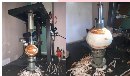
GAMBAR 9 (Proses Pengupasan Kulit Ari Kelapa)
