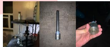
GAMBAR 5 (Pencekam Atas Dan Air Cylinder Eksisting)
