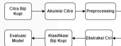
GAMBAR 6 Diagram Blok Klasifikasi Biji Kopi
