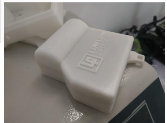
GAMBAR 10 HASIL PROTOTIPE CASING MENGGUNAKAN 3D PRINT
